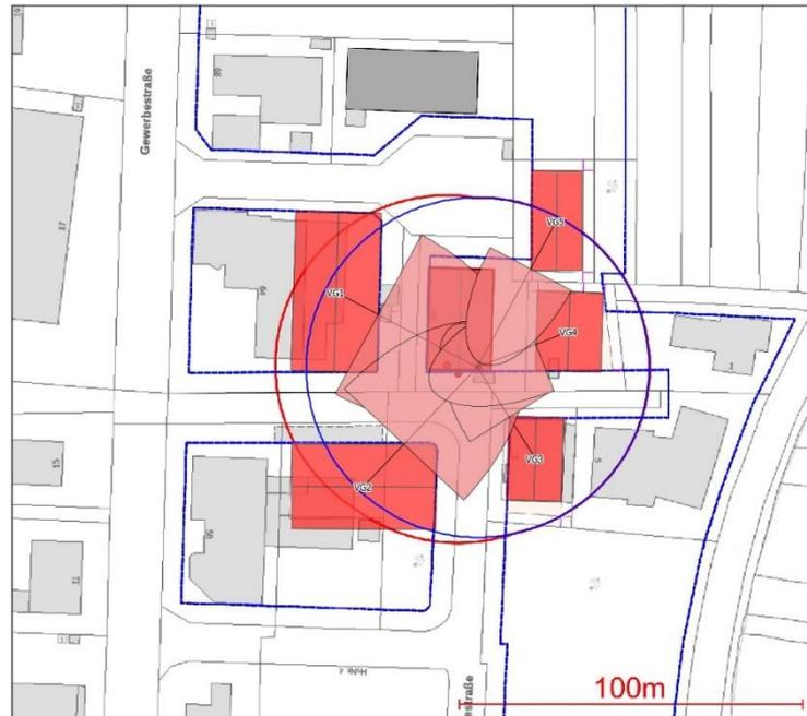
Abbildung 7-13: **Szenario 2, Schornstein 3**: Gebäude-Draufsicht und Ausdehnung der Rezirkulationszonen (rot hinterlegte Parabeln). Die Lage des Schornsteins ist als schwarzer Punkt gekennzeichnet. Der blaue Kreis markiert einen Abstand von 50 m um den Schornstein.
