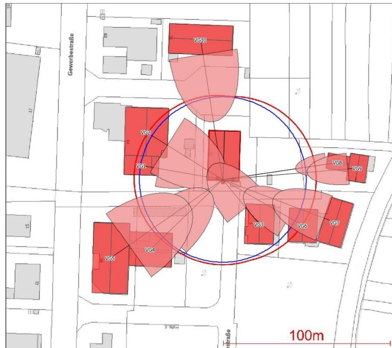
Abbildung 7-5: **Szenario 1, Schornstein 2:** Gebäude-Draufsicht und Ausdehnung der Rezirkulationszonen (rot hinterlegte Parabeln). Die Lage des Schornsteins ist als schwarzer Punkt gekennzeichnet. Der blaue Kreis markiert einen Abstand von 50 m um den Schornstein.
