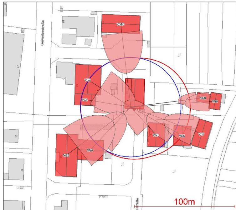
Abbildung 7-3: **Szenario 1, Schornstein 1:** Gebäude-Draufsicht und Ausdehnung der Rezirkulationszonen (rot hinterlegte Parabeln). Die Lage des Schornsteins ist als schwarzer Punkt gekennzeichnet. Der blaue Kreis markiert einen Abstand von 50 m um den Schornstein.
