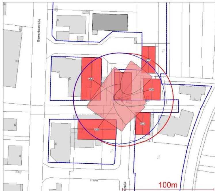
Abbildung 7-9: **Szenario 2, Schornstein 1**: Gebäude-Draufsicht und Ausdehnung der Rezirkulationszonen (rot hinterlegte Parabeln). Die Lage des Schornsteins ist als schwarzer Punkt gekennzeichnet. Der blaue Kreis markiert einen Abstand von 50 m um den Schornstein.
