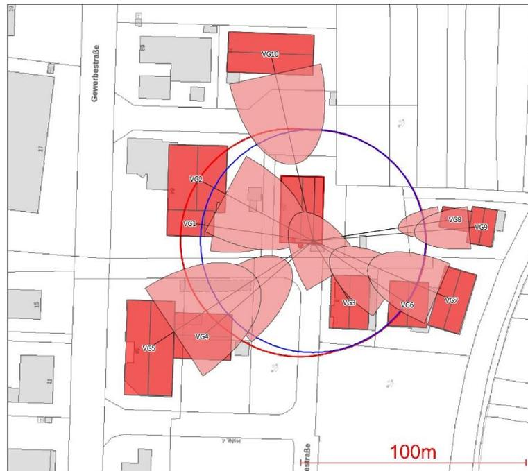
Abbildung 7-7: **Szenario 1, Schornstein 3:** Gebäude-Draufsicht und Ausdehnung der Rezirkulationszonen (rot hinterlegte Parabeln). Die Lage des Schornsteins ist als schwarzer Punkt gekennzeichnet. Der blaue Kreis markiert einen Abstand von 50 m um den Schornstein.
