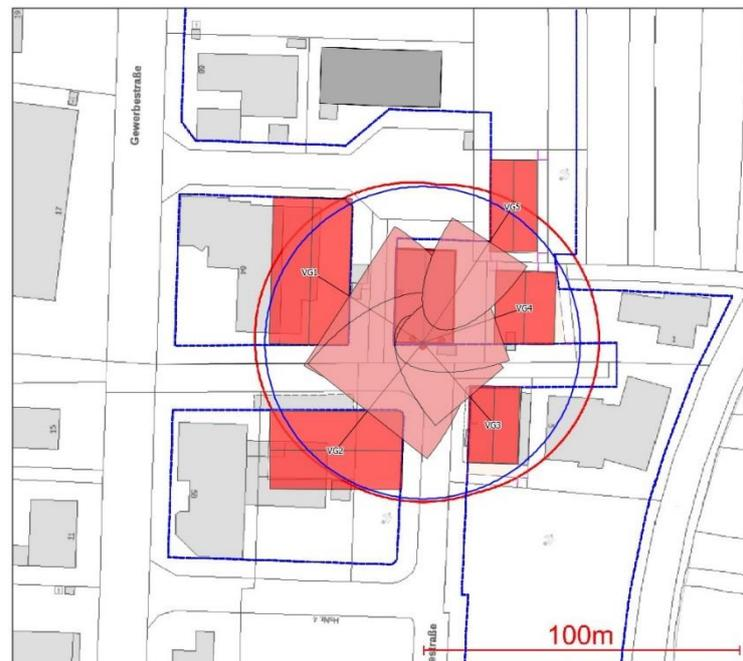
Abbildung 7-11: **Szenario 2, Schornstein 2:** Gebäude-Draufsicht und Ausdehnung der Rezirkulationszonen (rot hinterlegte Parabeln). Die Lage des Schornsteins ist als schwarzer Punkt gekennzeichnet. Der blaue Kreis markiert einen Abstand von 50 m um den Schornstein.
