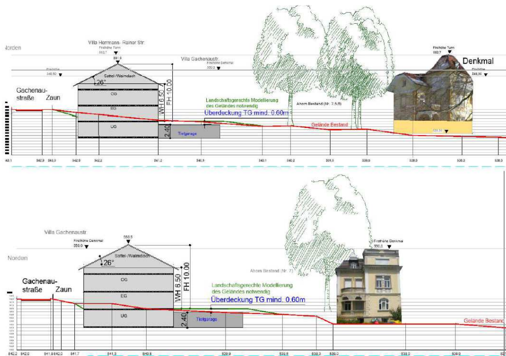
Schnittdarstellungen zur Verdeutlichung der Einbindung der geplanten Gebäude im Bezug zum Villenbestand (Auszug aus Präsentation Bauausschusssitzung 08.04.2019)
